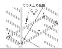
ガラス止め吸盤を、棚 フレームの上より、 W900タイプは6ヶ、 W500/400タイプは4ヶ を押しながら差し込み ます。
