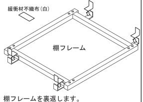
次に、緩衝材の不織布(白)の裏面の紙を不織 布が剥がれないように注意して剥がします。 そして、棚フレームの両サイドの4つのL字 (コ字)金物部に図のように貼り付けます。
