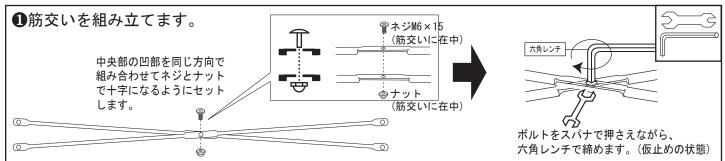
※筋交いは、棚板と同じ幅のモノをお使いください。棚板の幅と筋交いが合っていない状態では、組立できません。 ※筋交いは、強度部材ですので、必ずご使用ください。筋交い無しでは、ラックが自立しません。
