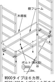
W500/400タイプは4カ所をボ ルトで締め込みます。
