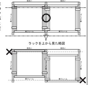
**⑦**設置場所に置き、背筋交い、棚フレ ームのボルトを本締めして、アジャ スター調整をします。
