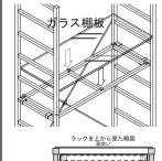
ガラス棚板を置く際は、側フ レームの縦支柱の前端と、ガ ラスの前縁が揃うように、置 いてください。
