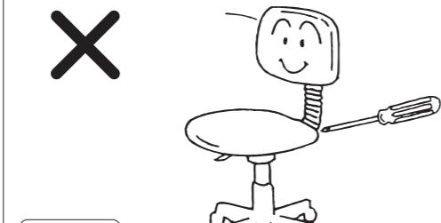
⚠️ 警告 各部の固定ネジにゆるみが発生した時は、増し締めをしてください。ゆるんだまま座ると本体が壊れてけがをすることがあります。
