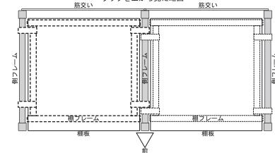
このことを念頭に置いて、最初の1連目は、上図の左側(太い 点線)のように、棚フレームの引っかけ部(L字金物部)が後ろ に来るように取り付けるようにすると良いでしょう。
