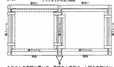
このことを念頭に置いて、最初の1連目は、上図の左側(太い点線)のように、棚フレームの引っかけ部(L字金物部)が後ろに来るように取り付けるようにすると良いでしょう。
