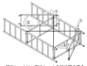
棚フレームは、側フレームの縦柱間を通る サイズですので、片側の側フレームを通り 抜けさせてから、もう片側の側フレームへ 掛けるようにしてください。
