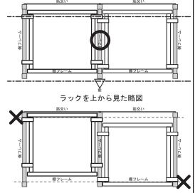
⑦設置場所に置き、背筋交い、棚フレ 一ムのボルトを本締めして、アジャ スター調整をします。
