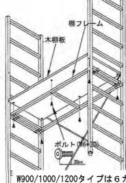
W900/1000/1200タイプは6カ 所、W500/400タイプは4カ所 をボルトで締め込みます。
