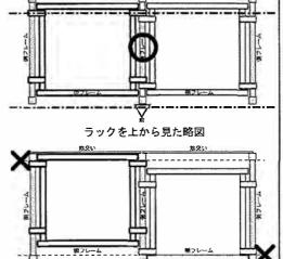
おいたでは、 で設置場所に置き、背筋交い、棚フレームのボルトを本締めして、アジャスター調整をします。
