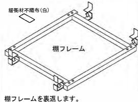
棚フレームを表返します。 次に、緩衝材の不織布(白)の裏面の紙を<u>不織</u> 布が剥がれないように注意して剥がします。 そして、棚フレームの両サイドの4つのL字 (コ字)金物部に図のように貼り付けます。
