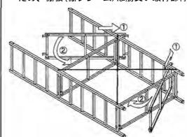
棚フレームは、側フレームの縦柱間を通るサイズですので、片側の側フレームを通り抜けさせてから、もう片側の側フレームへ掛けるようにしてください。
