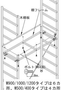
所、W500/400タイプは4カ所 ● をボルトで締め込みます。
