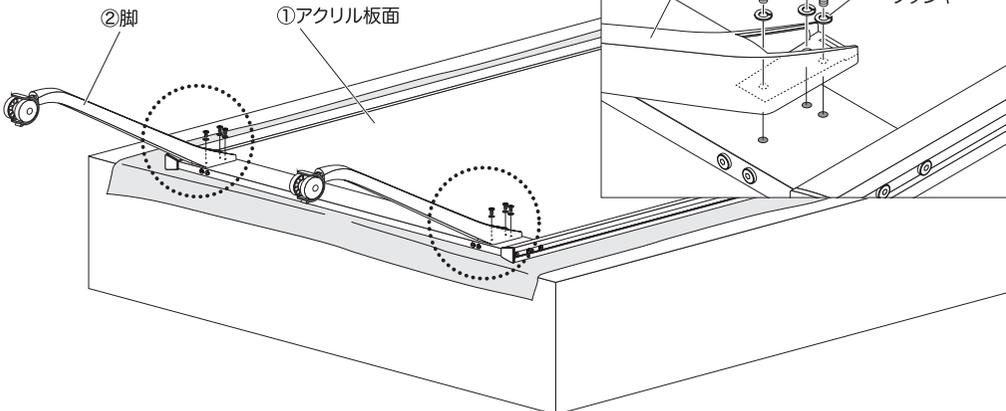
3. ネジ類がしっかり締め付けられているかを再度確認し、③脚カバーを矢印Aの位置に差し込みながら②脚に押し込んで取り付けてください。
