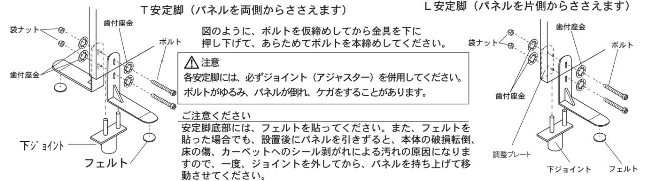
図のように、ボルトを仮締めしてから金具を下に押し下げて、あらためてボルトを本締めしてください。
