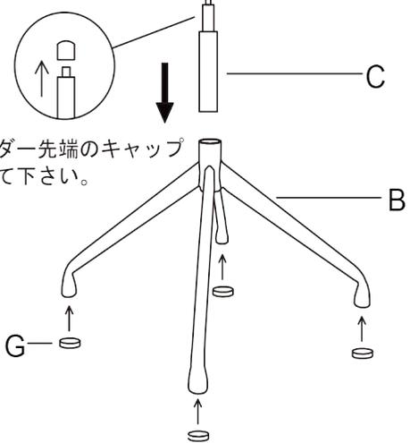
シリンダー先端のキャップを外して下さい。
