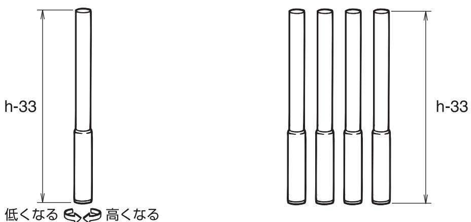
アジャスタを回して脚の高さを調整します。
