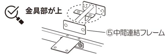
2. ⑥中間連結プレートを③連結フレーム側面（外側）の穴位置に合わせて、⑦ボルト（M8×12）に⑫ワッシャー（M8用）を入れて仮留めしてください。
