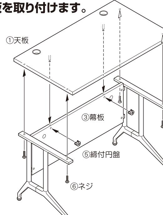
③幕板の上2ヶ所に⑤締付円盤を取り付け、十字溝のとがった部分をすべて穴方向に合わせます。下図のように脚と幕板が上から見て90°になっているのを確認して①天板を静かに載せます。(このとき③幕板の穴2ヶ所に①天板の締付ボルトが入るようにしてください。)⑤締付円盤を右へ回してロックしてください。⑥ネジ4本で①天板を②脚の下側から付属の六角レンチで固定してください。
