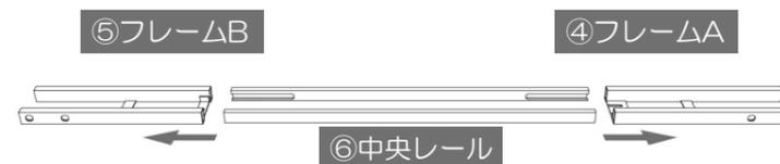
④フレームA、⑤フレームBの中から⑥中央レール2本を取り外してください。
