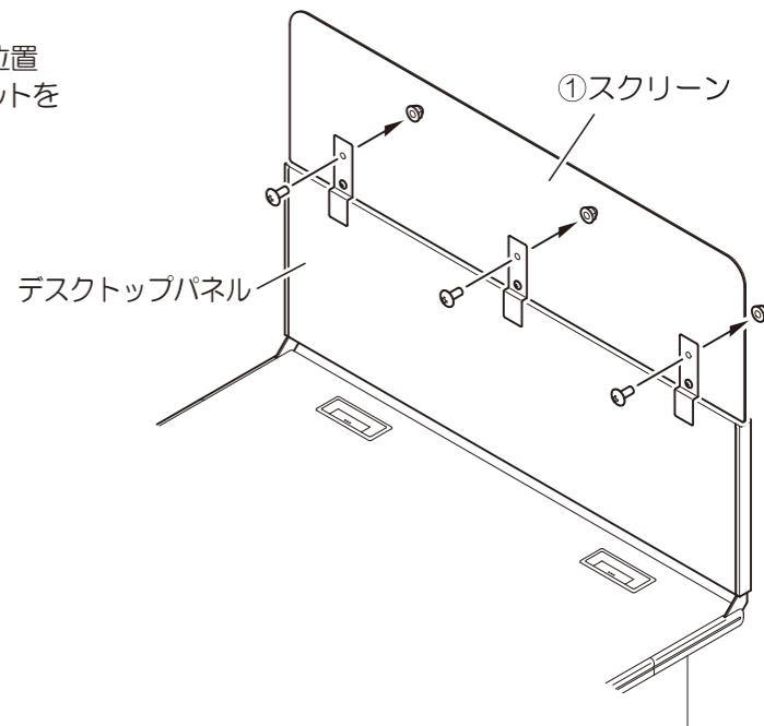
③トラスコネジと④袋ナットを締め込むと②取付金具がズレることがあります。
