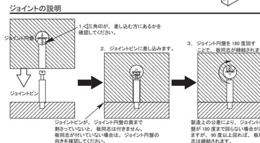
※ジョイント円盤は、付属の六角レンチ、+ドライバー (no.3) のどちらでも使用可能です。+ドライバーをご使用の場合、no.3 (太) を使用してください。no.2 以下のドライバーでは、ネジ頭 (十字穴) をなめる可能性があります。
