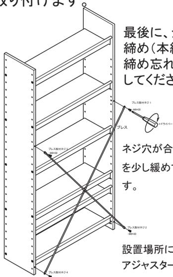
最後に、全てのネジをしっかりと締め(本締め)てください。ネジの締め忘れ、緩みがないかを確認してください。
