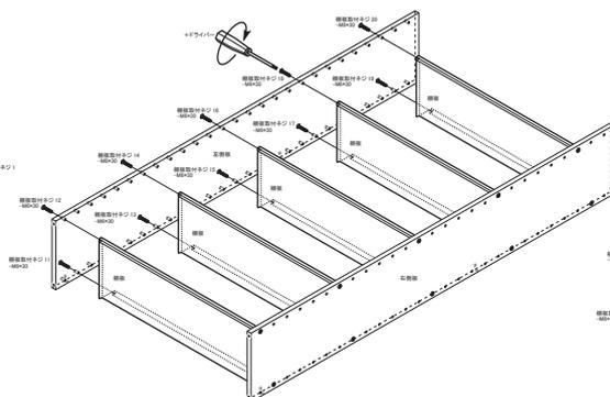
③ 組立 - 棚板を追加し、2で外したビスで、側板を取り付けます。
