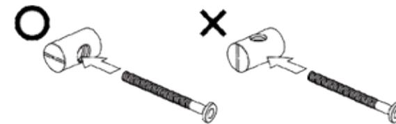
ナットの角度がずれているとボルトがスムーズに入りません。ボルトがスムーズに入らない場合には、ドライバーを使用しナットの角度を調整してください。
