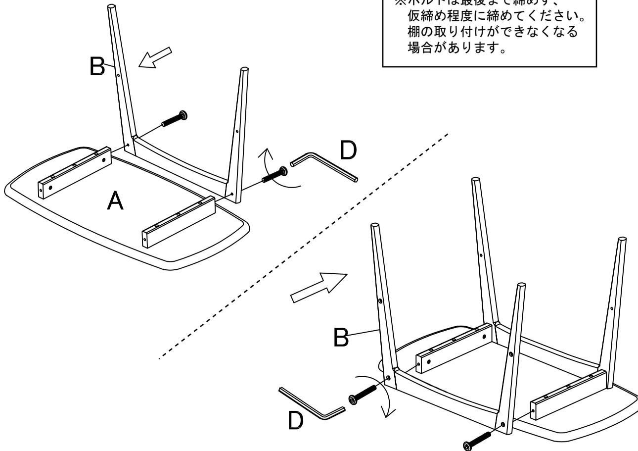
※ボルトは最後まで締めず、仮締め程度に締めてください。棚の取り付けができなくなる場合があります。
