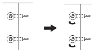
はめ込み時に ▼印を連結ピンの方向に向ける
