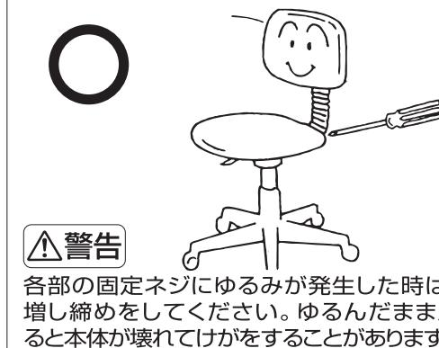
⚠️ 警告 各部の固定ネジにゆるみが発生した時は、増し締めをしてください。ゆるんだまま座ると本体が壊れてしまうことがあります。
