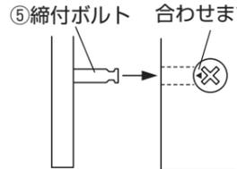
⑤締付けボルトを取り付けた板を穴に合わせて差し込みます。
