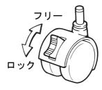
ワゴンには2ヶ所ストッパー付キャスターが付いています。レバーをフリー方向(上側)に倒すと車輪が回転可能になり、ロック方向(下側)に倒すと車輪がロックされます。
