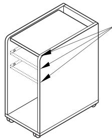
組立時に天板のセット位置 を3段階に調整できます。 (H=525、465、405mm)
