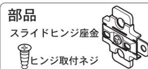
スライドヒンジ座金を取り付けます。取付に際し、使用するネジは、+ドライバーno.2(中)をご使用ください。
