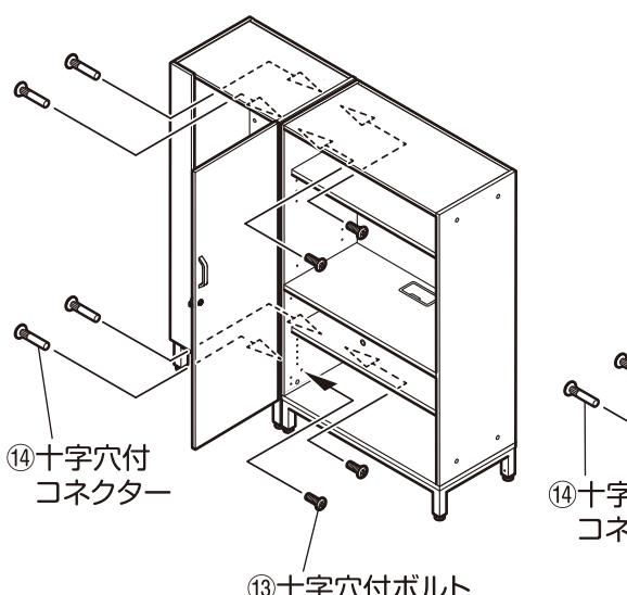
⑭十字穴付コネクターを連結穴に差し込み最後まで差し込まれた事を確認し、⑬十字穴付ボルトで固定してください。(4ヶ所)
